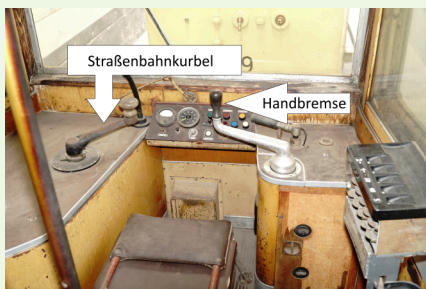
Fahrstand der historischen Straßenbahn (Abb. 1)
